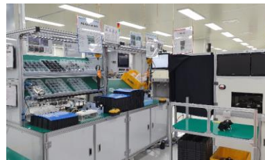
HVAC Blower PWM 조립
