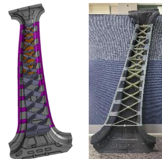
Multi-material B- Pillar (Steel + CFRP + GFRP)
