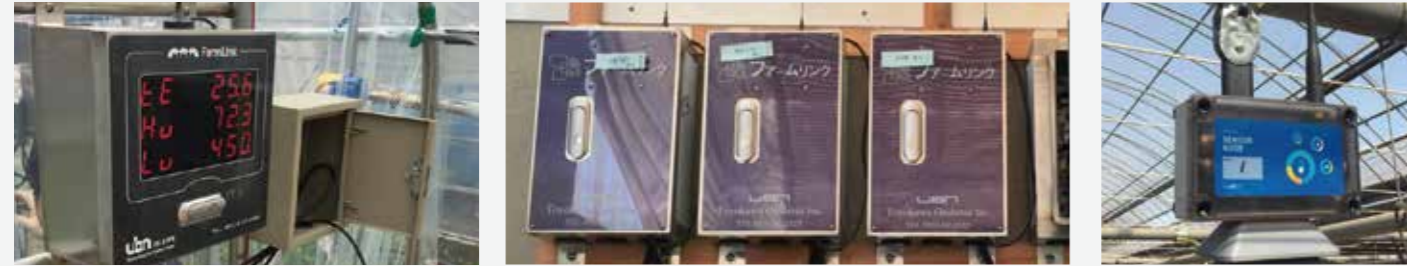
▲ 네트워크 컨트롤러 ▲ 무선 구동기 컨트롤러 ▲ 무선센서노드
